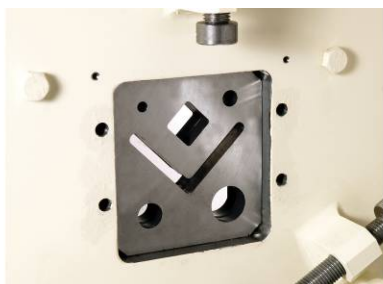
Rúdanyag és idomacél daraboló egység fix és mozgatható pengékkel
