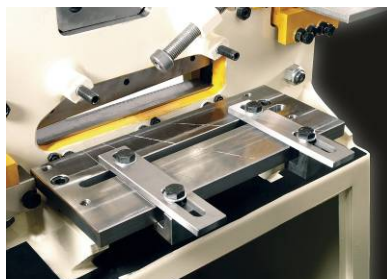
Forgatható, méretre állítható vezető sínek – pontos anyagmegvezetés
